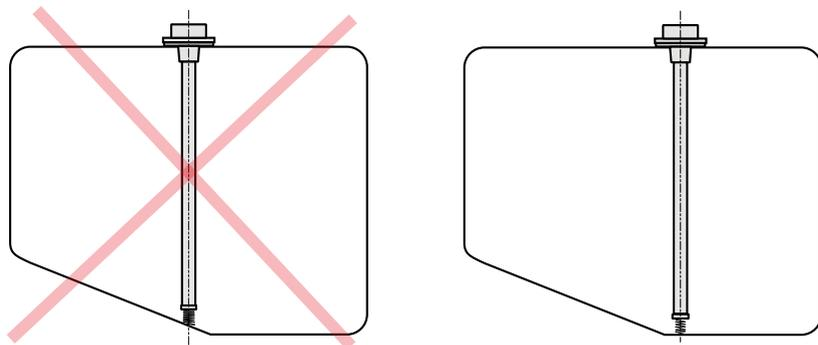
Рис.12. Пример установки ДУТ с пружинным донным упором
