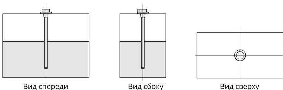
Рис.4. Рекомендованный вариант установки датчика в бак
